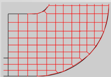
TAG-Netz für eine genaue Darstellung der Gussgeometrie
