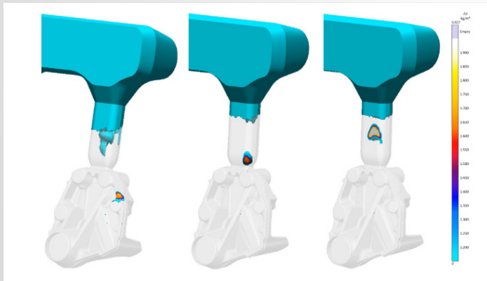
Eine genaue Beschreibung der Schmelzefront zeigt Lufteinschlüsse im Gießsystem
