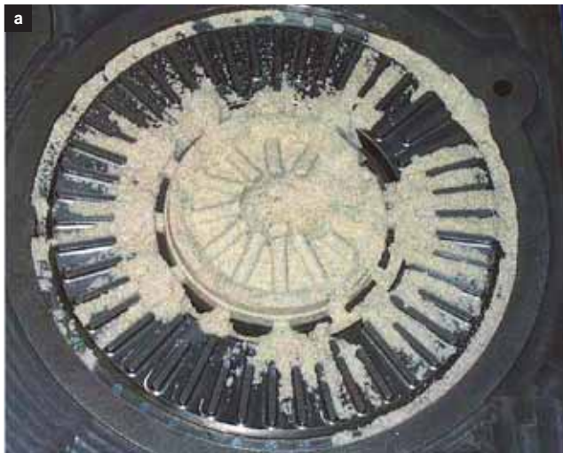
Bild 5: Teilgefülltes Kernwerkzeug nach Abbruch des Schießprozesses (a) und Simulation des Kernschießens für einen Bremscheibenkern (b). Die Simulation erlaubt beliebige Momentaufnahmen und die Beobachtung von Fließvorgängen, die experimentell nicht zugänglich sind. Die Bewertung des „angehaltenen“ Experiments ist nicht unproblematisch und mit erheblichem Aufwand verbunden.
