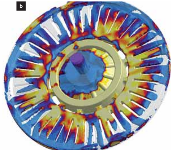
Bild 5: Teilgefülltes Kernwerkzeug nach Abbruch des Schießprozesses (a) und Simulation des Kernschießens für einen Bremscheibenkern (b). Die Simulation erlaubt beliebige Momentaufnahmen und die Beobachtung von Fließvorgängen, die experimentell nicht zugänglich sind. Die Bewertung des „angehaltenen“ Experiments ist nicht unproblematisch und mit erheblichem Aufwand verbunden.
