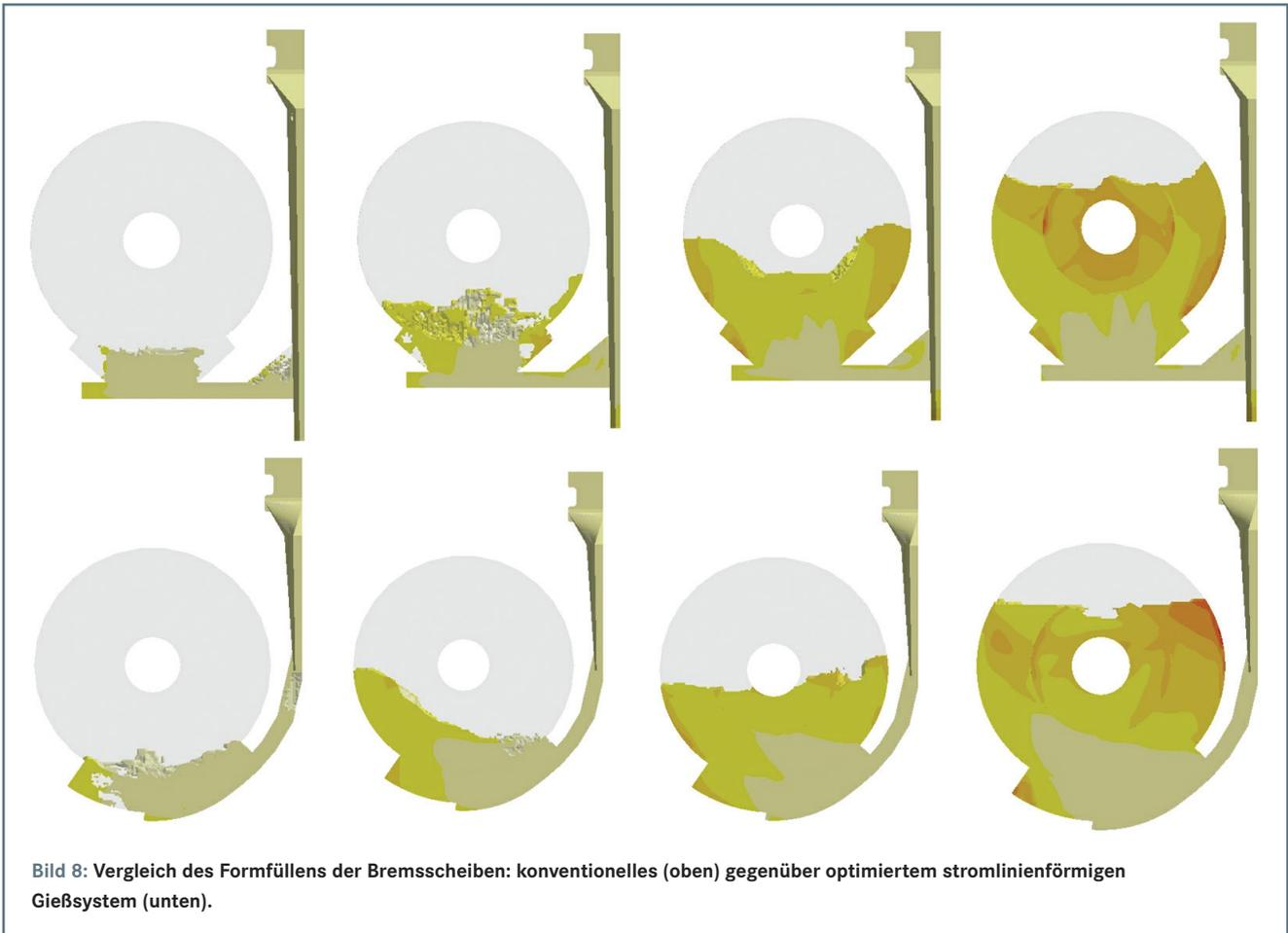
Bild 8: Vergleich des Formfüllens der Bremsscheiben: konventionelles (oben) gegenüber optimiertem stromlinienförmigen Gießsystem (unten).
