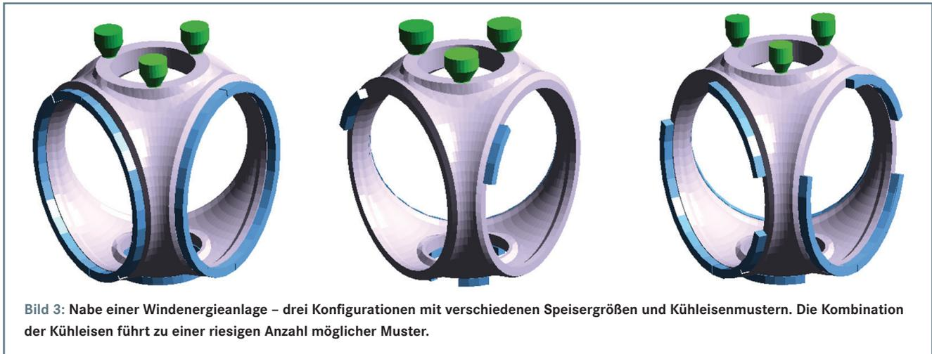
**Bild 3:** Nabe einer Windenergieanlage – drei Konfigurationen mit verschiedenen Speisergrößen und Kühlleisenmustern. Die Kombination der Kühlleisen führt zu einer riesigen Anzahl möglicher Muster.
