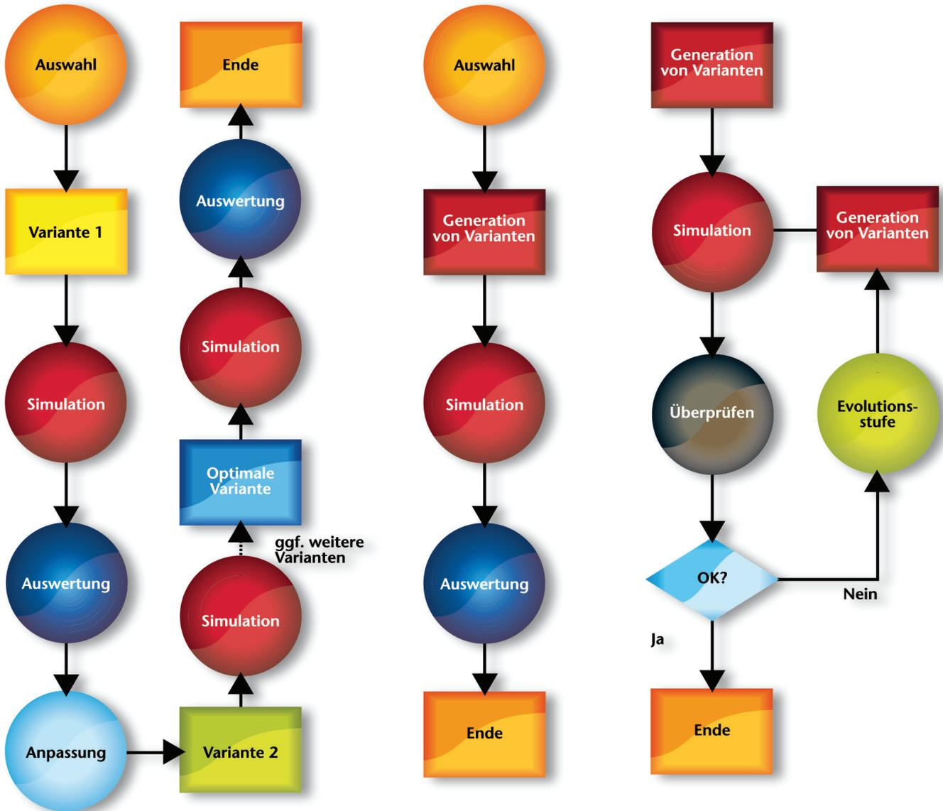
Bild 1: Ablaufschemata: eindimensionale Suche (links), Versuchsplanung (Mitte), automatische Optimierung (rechts).
