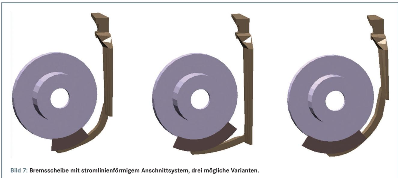
**Bild 7: Bremscheibe mit stromlinienförmigem Anschnittsystem, drei mögliche Varianten.**
