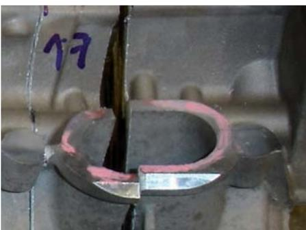
(a) Schnitt durch undichten Zylinderkopf
