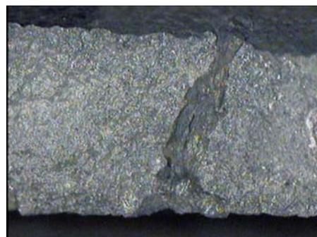
(b) Bruchstelle durch undichte Wand
