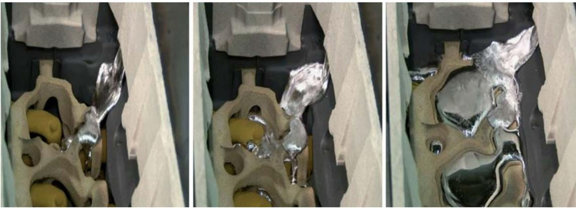
Abb. 3: Änderung der Strömungsrichtung während der Formfüllung eines Zylinderkopfes. Der Deckkern wurde so präpariert, dass der Strömungsverlauf der Schmelze vom Gießlauf über den Anschnitt mit einer Hochgeschwindigkeitskamera aufgenommen werden kann.
