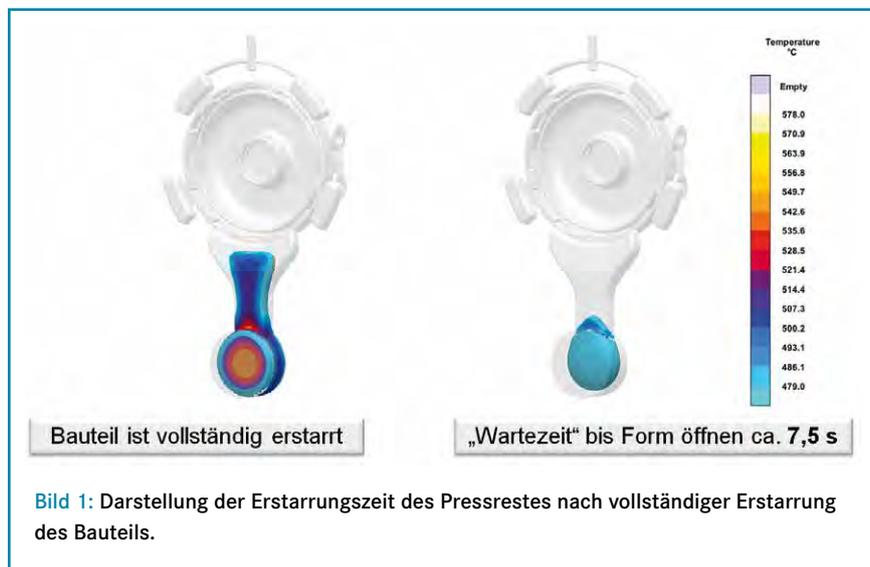
Bild 1: Darstellung der Erstarrungszeit des Pressrestes nach vollständiger Erstarrung des Bauteils.
