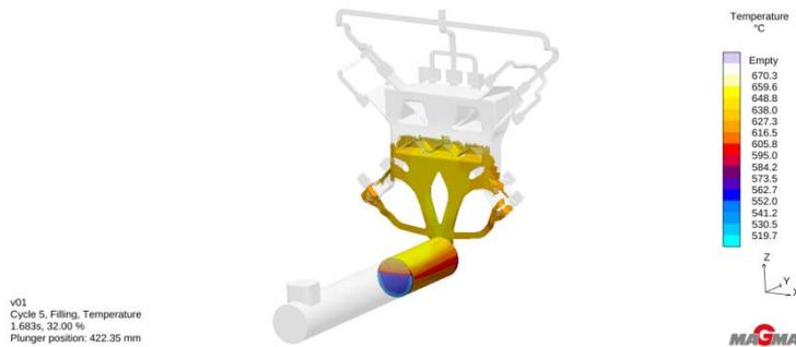
Bild 1: Dosierung und Schussprofil in der Schusskammer.
