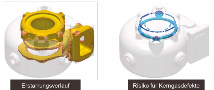
Risikobereiche für Kerngasdefekte in Abhängigkeit der lokalen Erstarrungsbedingungen und Binderzersetzung
