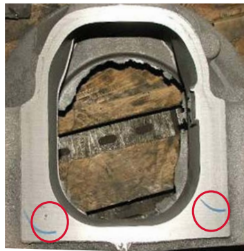
Lokale Perlitanteile in einem Kurbelgehäuse aus GJS
