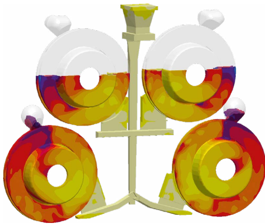
Formfüllung von vier Bremsscheiben aus GJL
