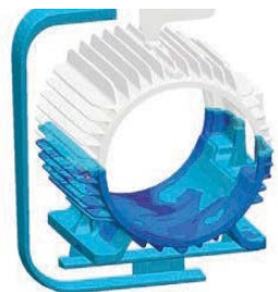
Lufteinschlüsse im ursprünglichen (oben) und im optimierten (unten) Gießsystem
