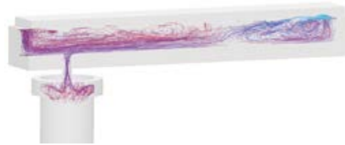
Tracerteilchen visualisieren Strömung in der Gießrinne
