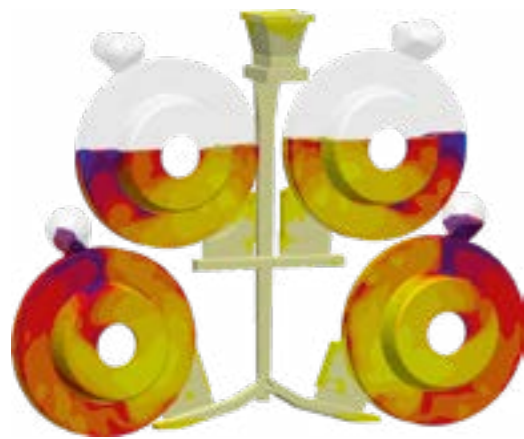
Formfüllung von vier Bremscheiben aus GJL
