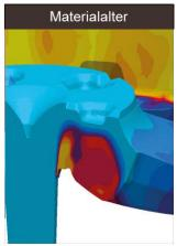
MAGMASOFT®-Ergebnissen zur Formfüllung und Analyse potentieller Gussfehler wie Kaltlauf oder Oxideinschlüsse
