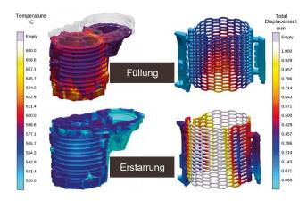
Deformation von Sandkernen über Formfüllung und Erstarrung
