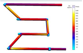
Lokale Wärmeübergangskoeffizienten, berechnet auf Basis der Strömungsbedingungen in Kühlkanälen
