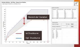
Assistenten zur Abschätzung der Druckbedingungen für Füllung von Steigrohr, Gussteil und Kavität
