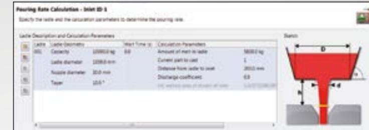
Strömung aus der Stopfenpfanne – berechnet aus Pfannengeometrie und aktueller Schmelzemenge
