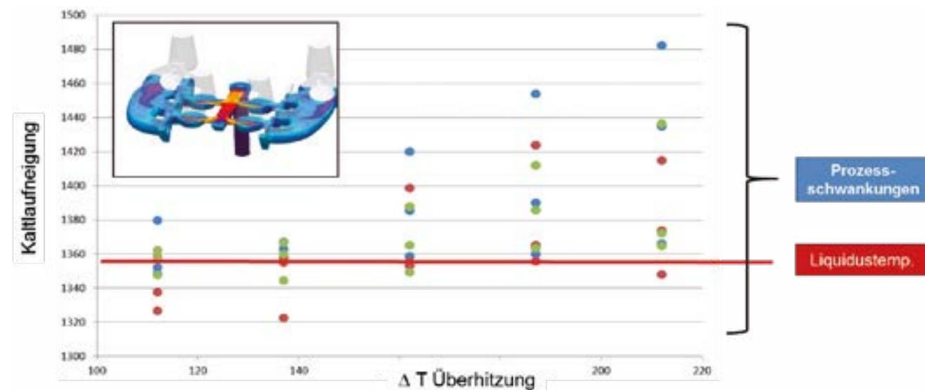
Ermittlung von robusten Prozessbedingungen, hier: Kaltlaufzeit für unterschiedliche Gießtemperaturen und typische Prozessschwankungen
