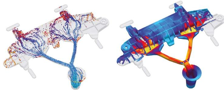
Visualisierung der Formfüllung: Tracer und Strömungsgeschwindigkeiten
