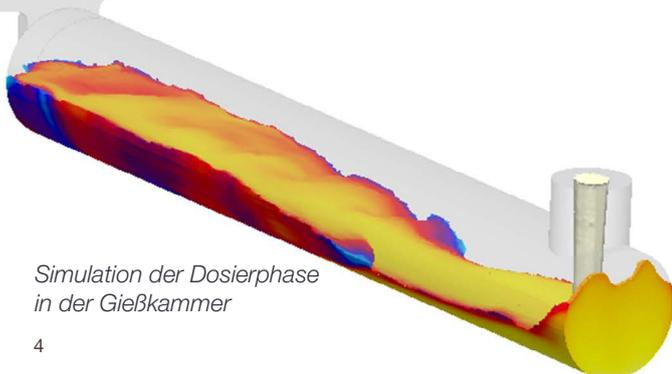
Simulation der Dosierphase in der Gießkammer
