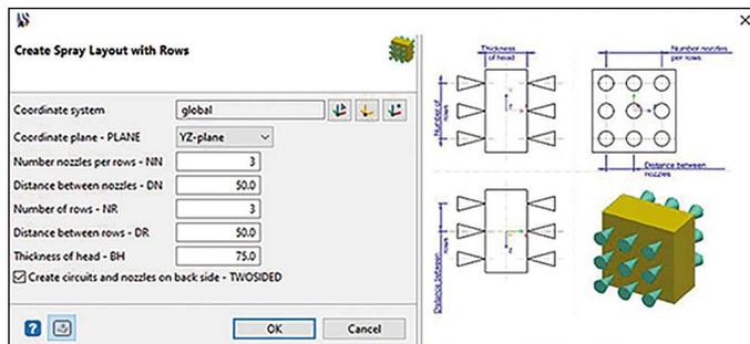
MAGMASOFT® ermöglicht die Erzeugung eigener parametrischer Geometrien, bietet eine umfangreiche Geometriedatenbank und erlaubt eine einfache Segmentierung komplexer CAD-Modelldaten mittels der 'Cutting Knife'-Funktion.
