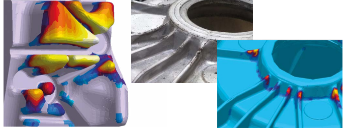
Vorhersage kritischer Werkzeugbereiche und deren Lebensdauer
