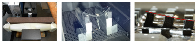
Tests von Kernen bei hohen Temperaturen – 3-Punkt Biegung, Kriechen und Auftrieb
