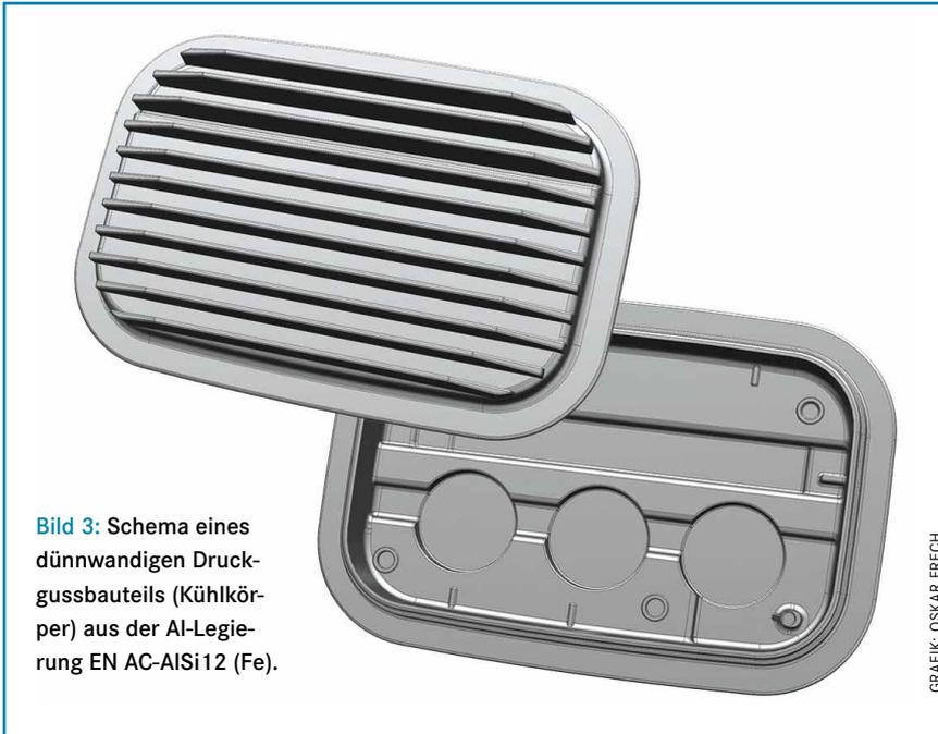
**Bild 3:** Schema eines dünnwandigen Druckgussbauteils (Kühlkörper) aus der Al-Legierung EN AC-AISi12 (Fe).
