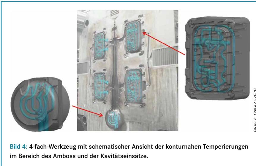
**Bild 4:** 4-fach-Werkzeug mit schematischer Ansicht der konturnahen Temperierungen im Bereich des Amboss und der Kavitätseinsätze.
