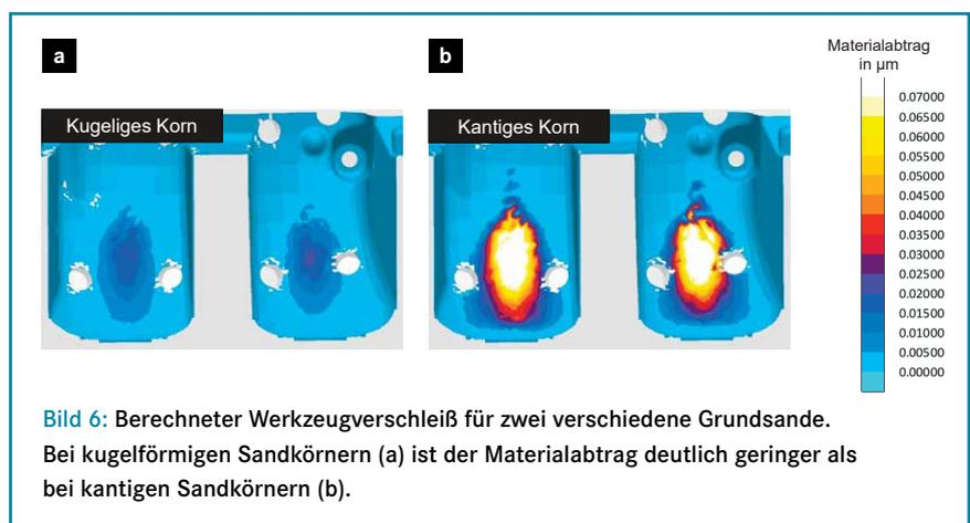
**Bild 6:** Berechneter Werkzeugverschleiß für zwei verschiedene Grundsande. Bei kugelförmigen Sandkörnern (a) ist der Materialabtrag deutlich geringer als bei kantigen Sandkörnern (b).
